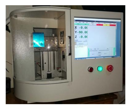
在"十二五"规划中,高效的装备制造被列入战略性新兴产业。小五轴联动数控机床是装备制造的一个重要组成部分,也是显示国家技术实力和工业制造能力的一项重要指标。企业对员工与学生的动手能力提出了更高的要求,为适应这种变化,教学型五轴数控机床应运而生。米控小型五轴联动数控加工中心一款具有价格低廉、小巧便携;配置高速高刚性电主轴,高精度摇篮式工作台;采用高刚性滚珠丝杠,三轴快移速度高达10M/min□进给加速度6M/min□加工精度可达0.03mm□摇篮工作台可实现A轴120□C轴马达360多角度加工等特点。
