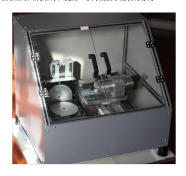
小五轴联动加工中心技术参数技术优势◇采用高精度丝杆导轨,保证加工精度◇内藏式高转速、高精度主轴,适合高速切削◇涡轮、蜗杆经特殊热处理,极限条件下耐磨损◇可以与世界前列的CAM系统无缝结合设备功能◇精密曲面零件加工◇一般模具加工◇复杂模具及小型复杂类箱体零件加工◇小型叶轮叶片加工、复杂空间曲面加工应用领域航空、航天、科研、精密器械、高精医疗设备等行业具有复杂曲面零部件的加工,小五轴联动数控加工教学示范。宁海数控小五轴哪家好五轴加工比其他的机床加工有什么优点吗?
