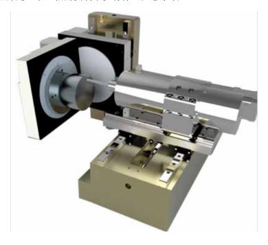
在小五轴加工中,采用平底铣刀对复杂的模具加工表面保持垂直状态,对减少加工时间有极大的帮助。基
